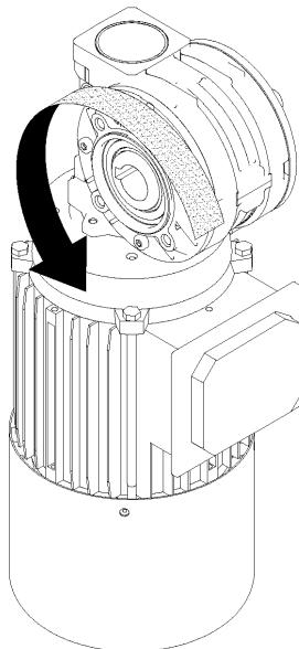
*Рисунок 8-2. Направление вращения двигателя при закрывании ворот.*
