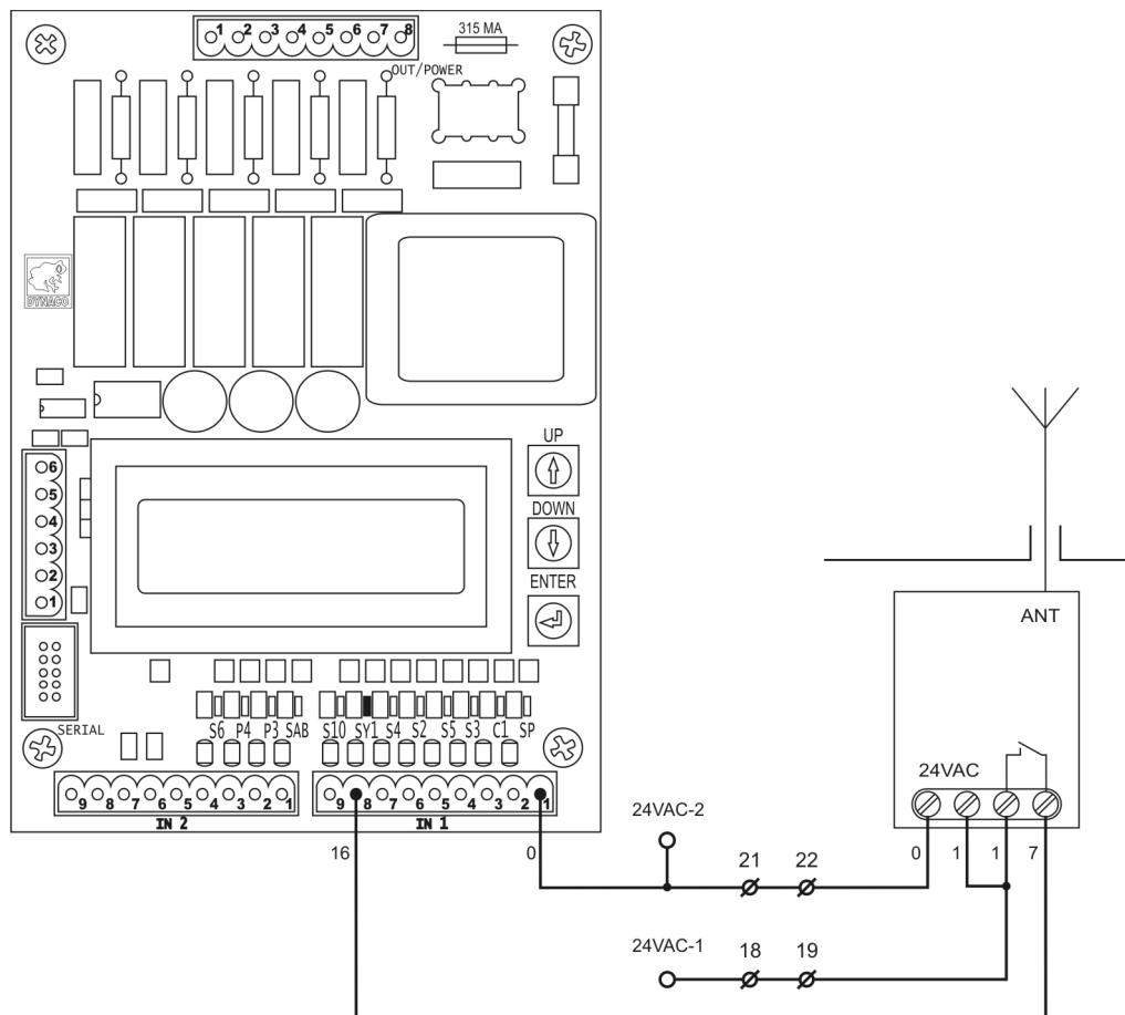
Рисунок 7-30. Подключение приёмника дистанционного управления REC1
