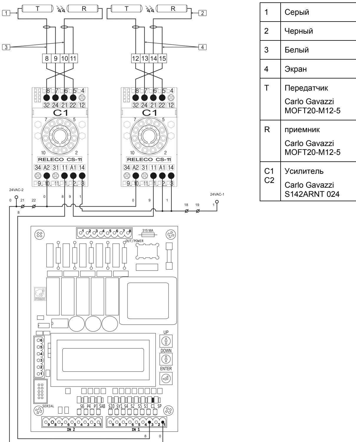
Рисунок 7-28. Подключение двух фотодатчиков безопасности.
