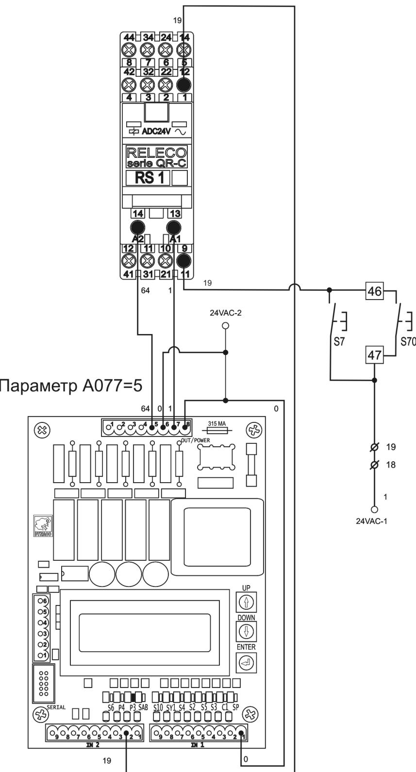
Рисунок 7-16. Подключение кнопки «вторая высота открывания».
