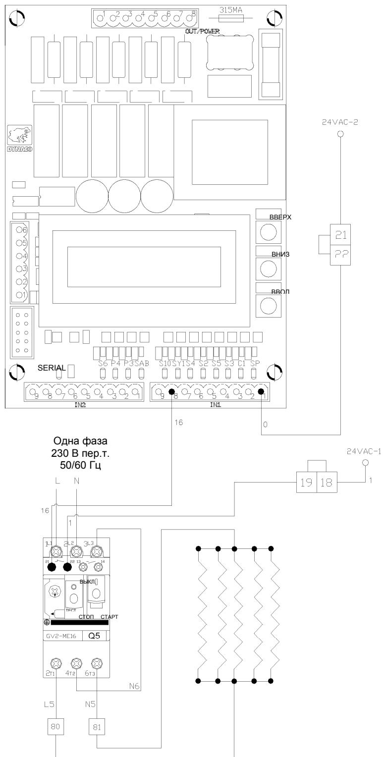
Рисунок 7-21. : Соединение кабелей обогрева (для модели Freezer).
