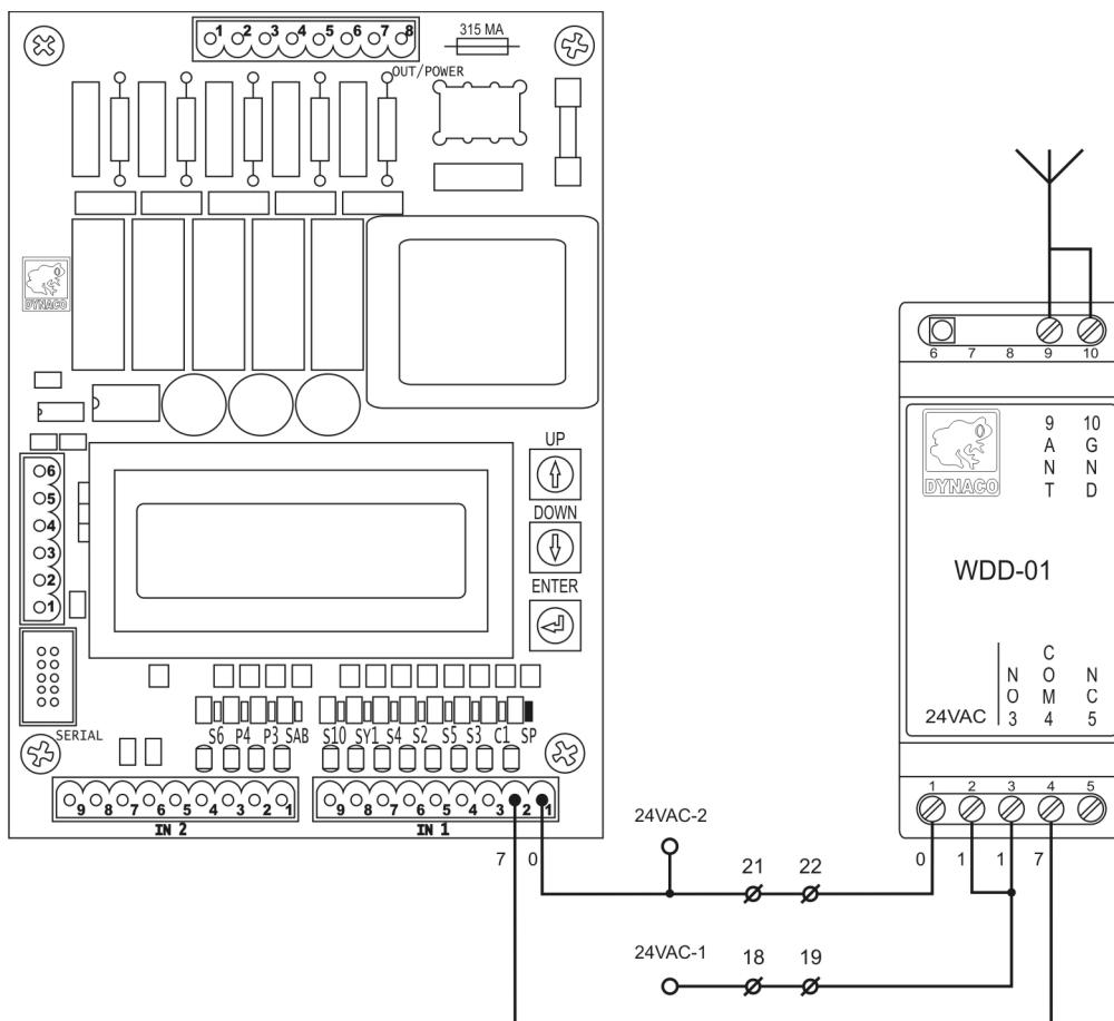
Рисунок 7-32. Подключение WDD.
