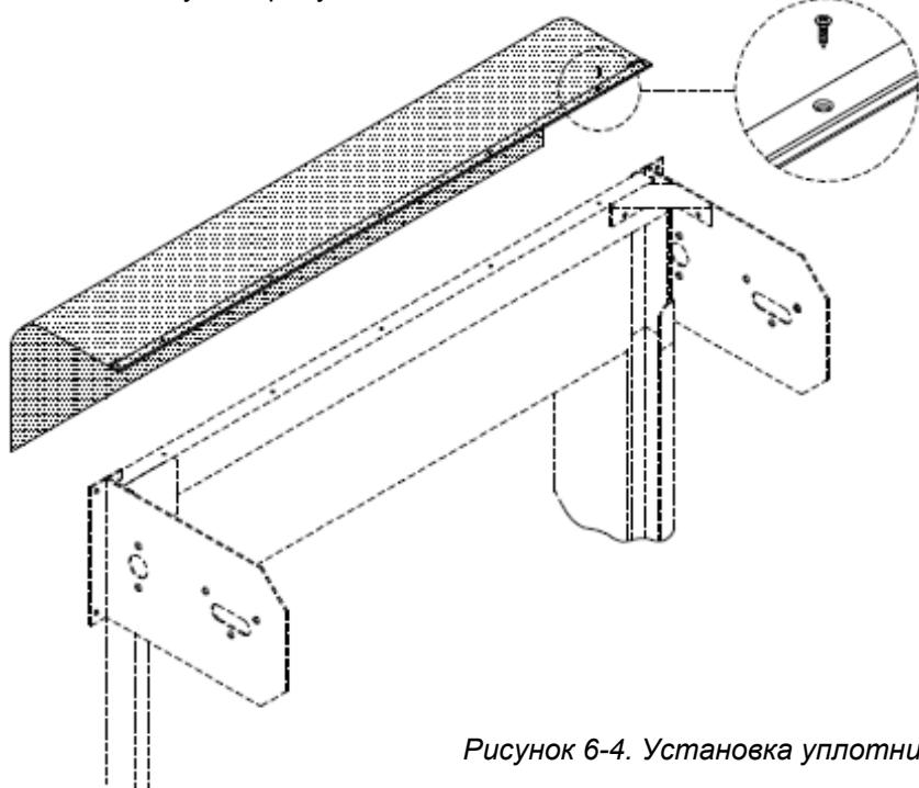
Рисунок 6-4. Установка уплотнительного полотна
