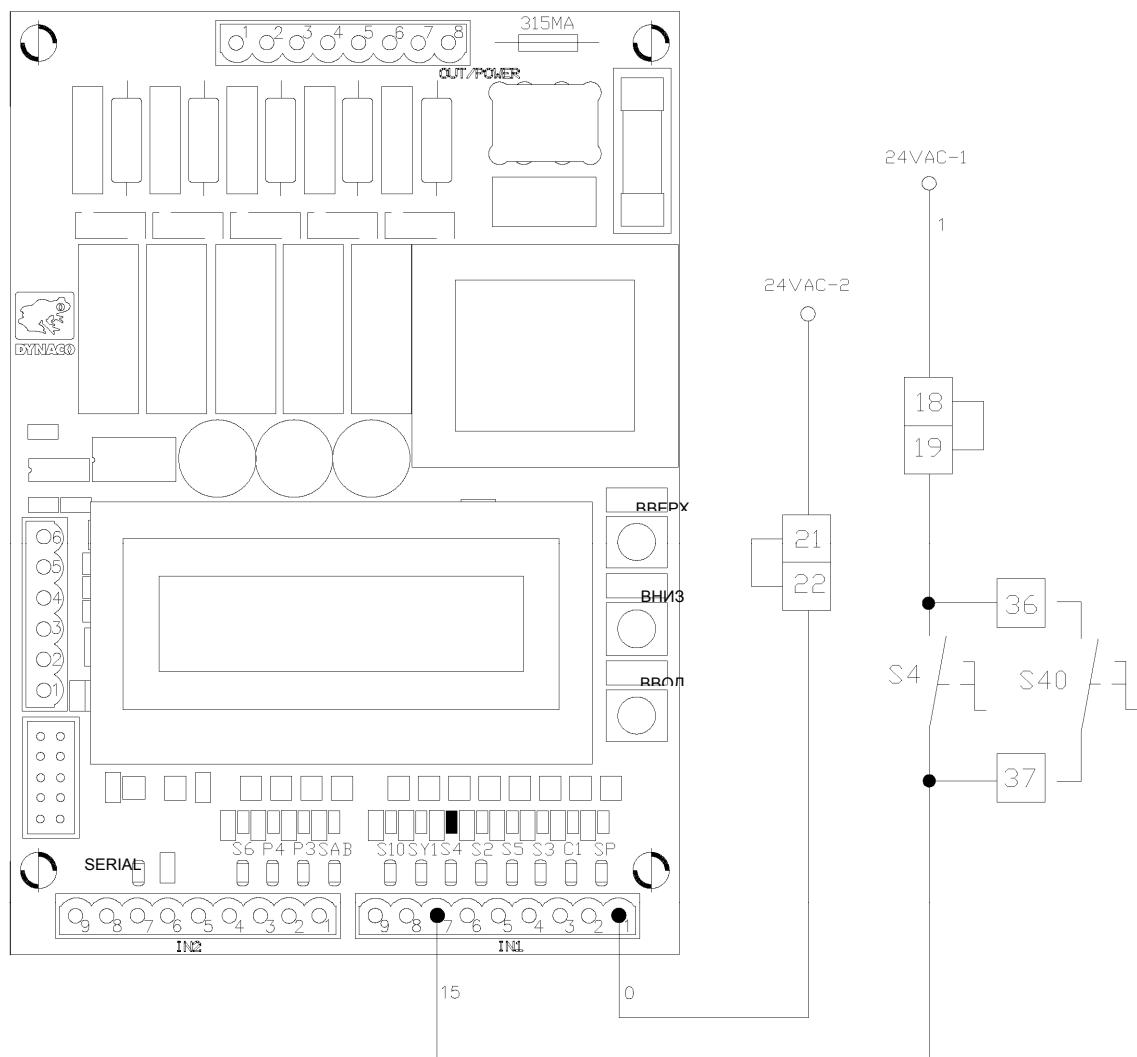
Рисунок 7-10. Соединение автом./ручен.
