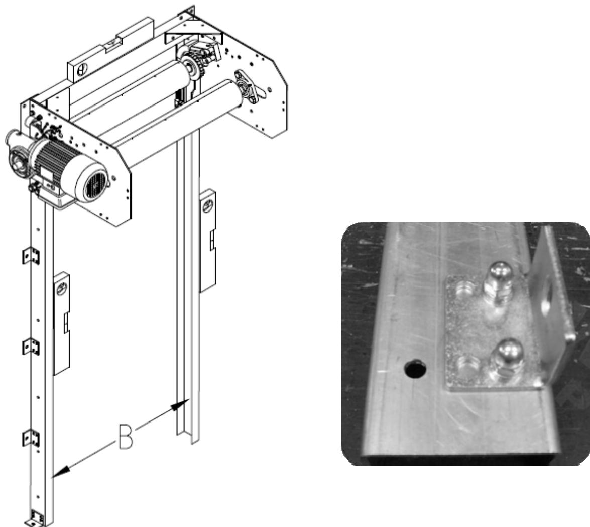
Рисунок 6-7. Крепление к стене
