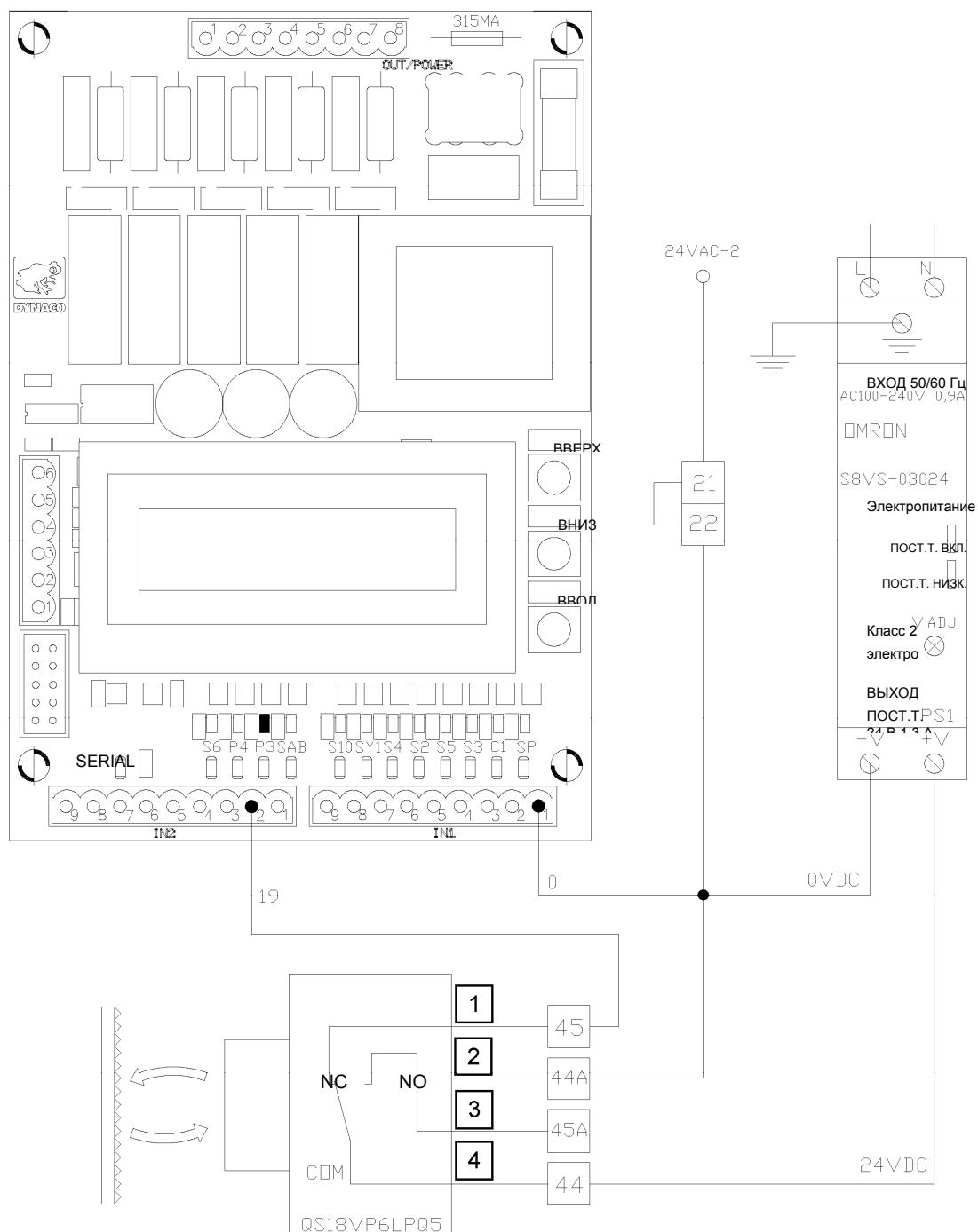
Рисунок 7-20. Соединение аварийного фотоэлемента 2 в 1.
