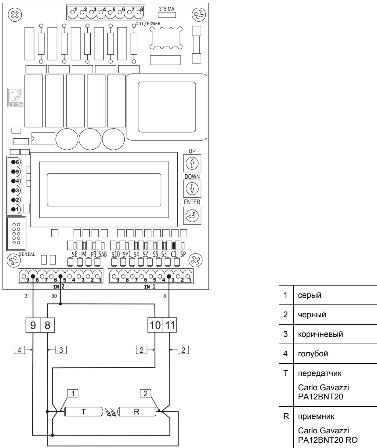
Рисунок 7-6. Подключение к плате управления фотоэлемента без усилителя.
