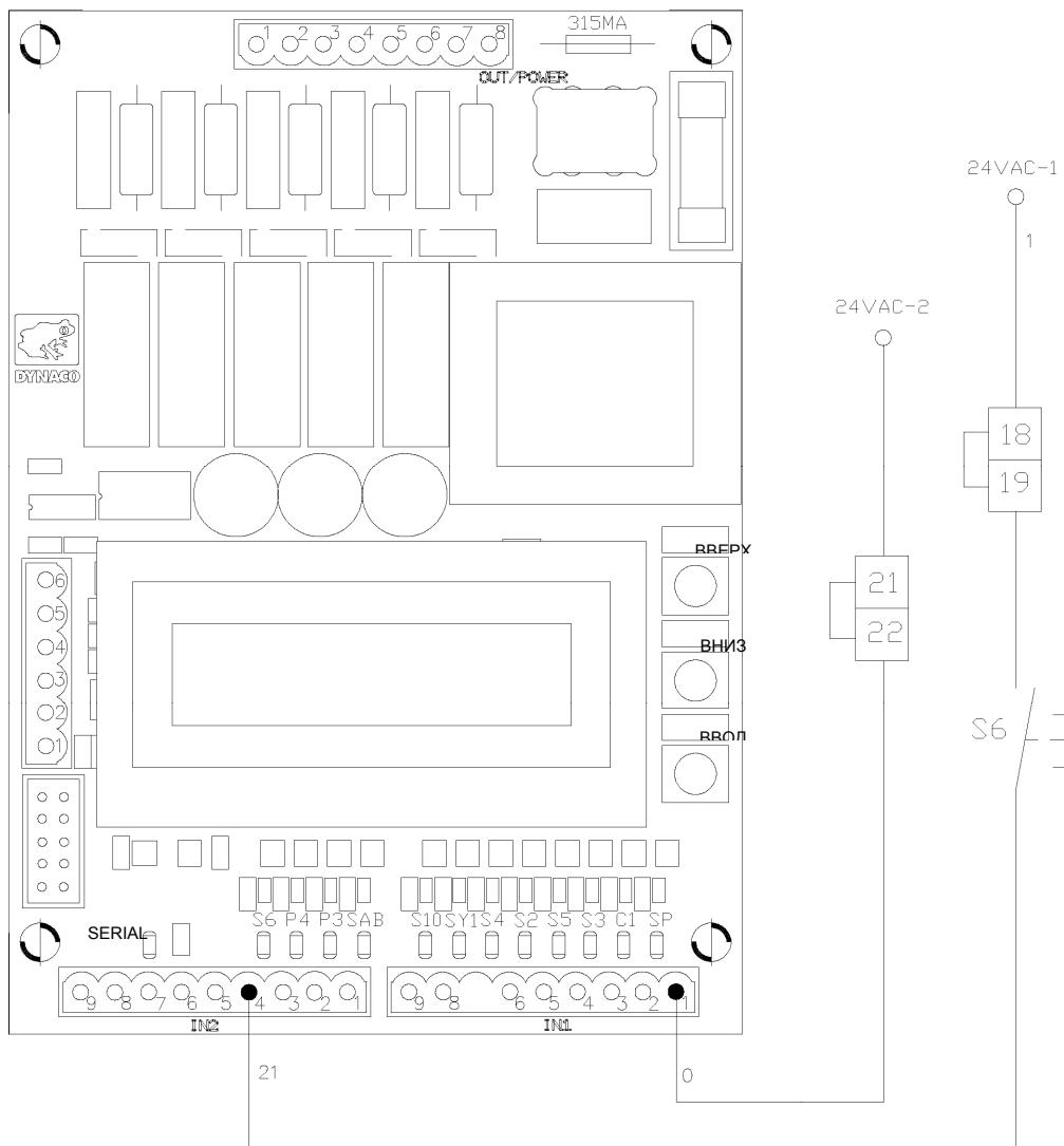
Рисунок 7-25. Подключение кнопки «очистка S6» (опция).
