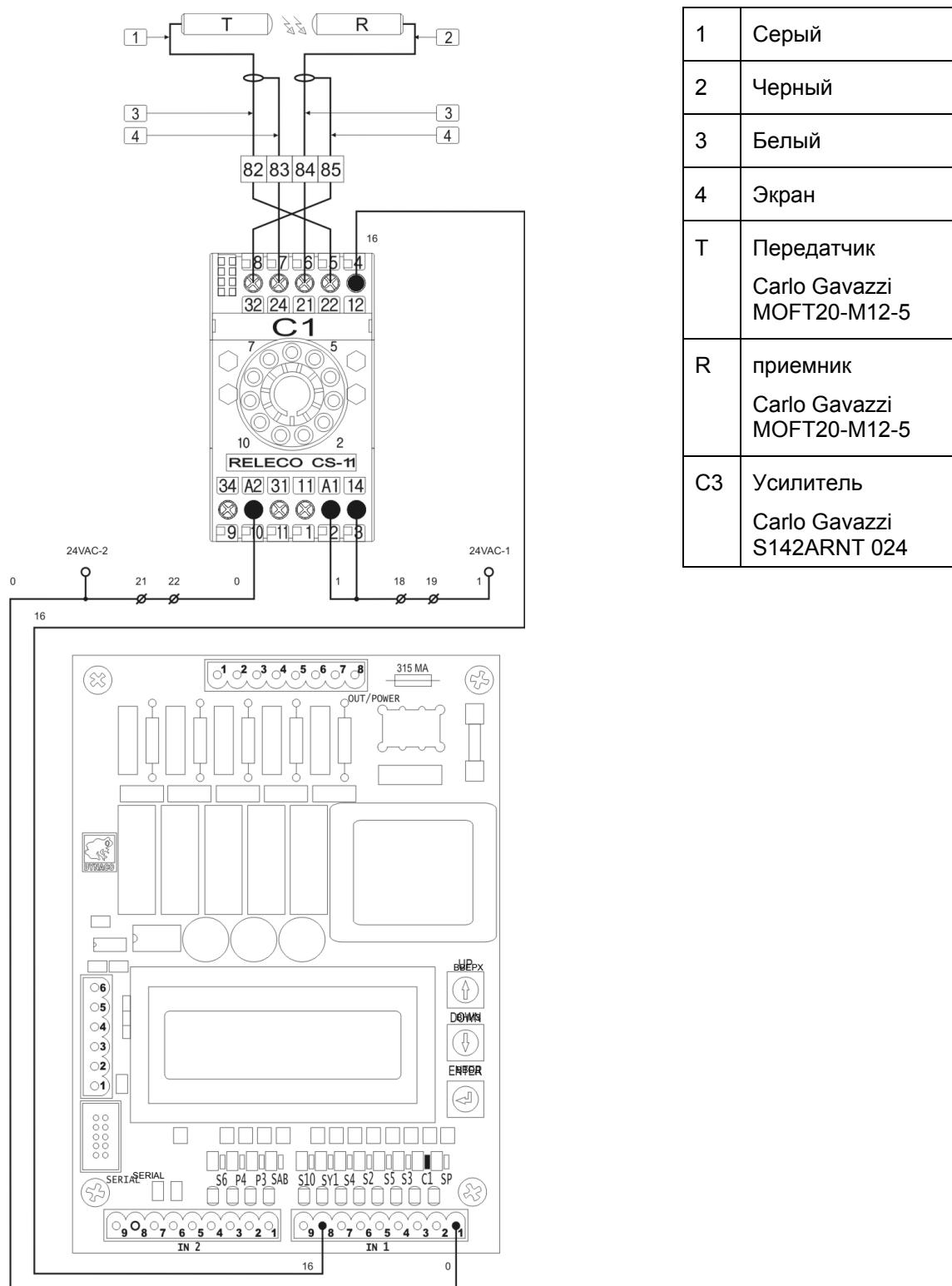
Рисунок 7-29. Подключение фотодатчика с усилителем в качестве сигнала управления.
