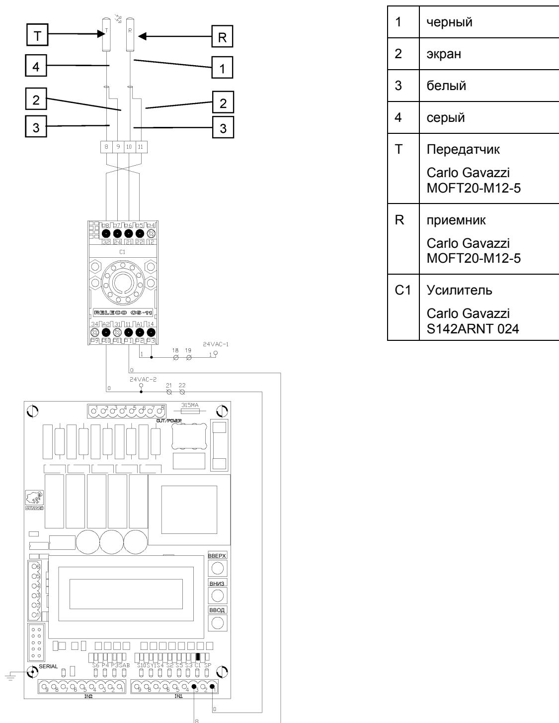
Рисунок 7-7. Подключение фотоэлемента к плате управления.
