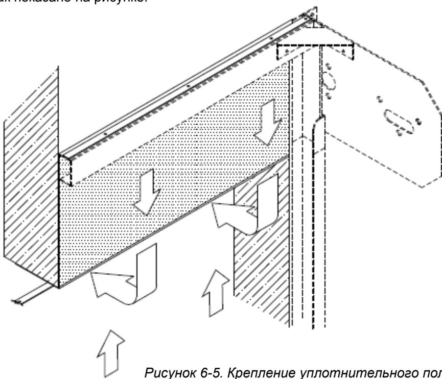
Рисунок 6-5. Крепление уплотнительного полотна на стене
