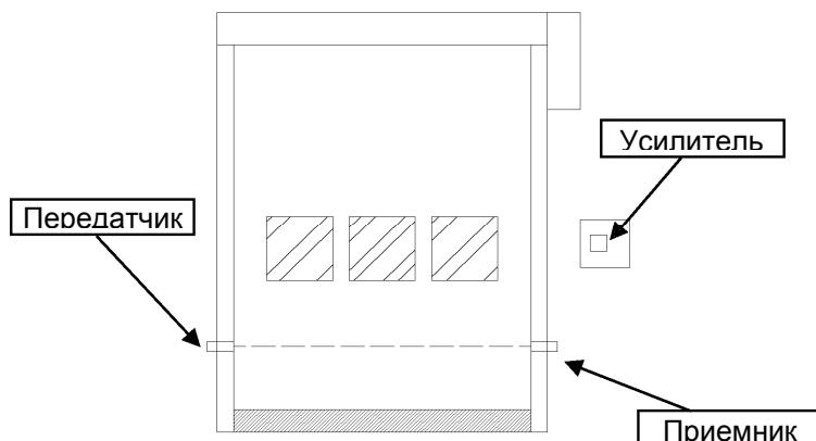
Рисунок 7-8. Фотоэлемент
