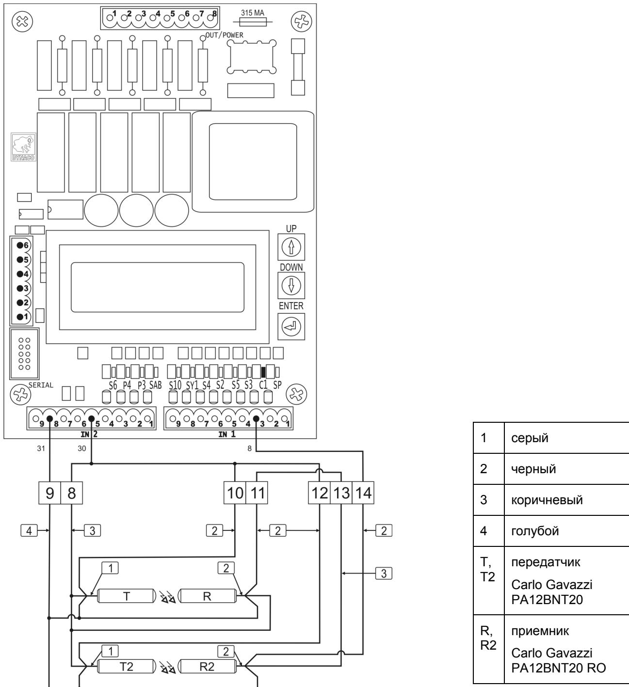
Рисунок 7-27. Подключение к плате управления пары фотодатчиков безопасности без усилителя.
