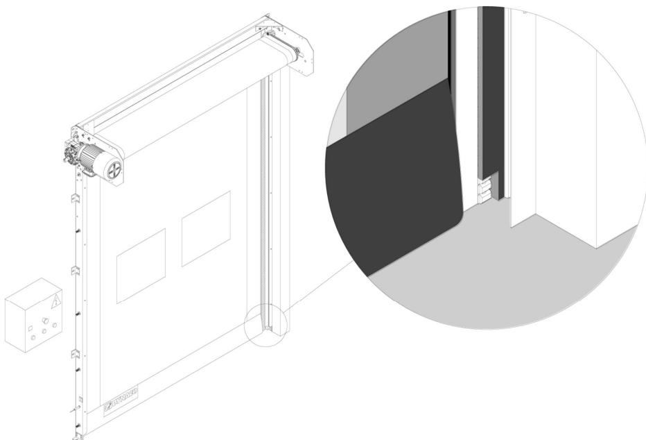
*Рисунок 6-12. Положение зиппера в закрытом состоянии ворот.*
