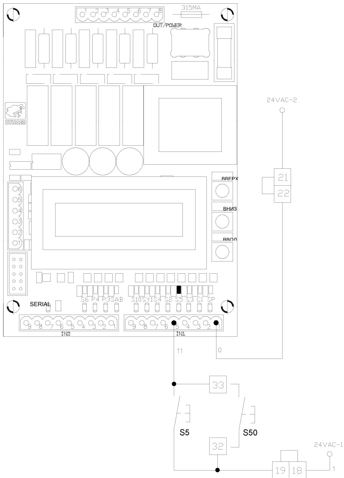
Рисунок 7-17. Подключение кнопки «закрыть».
