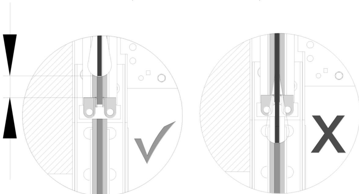
*Рисунок 6-11. Положение зиппера в открытом состоянии ворот.*
