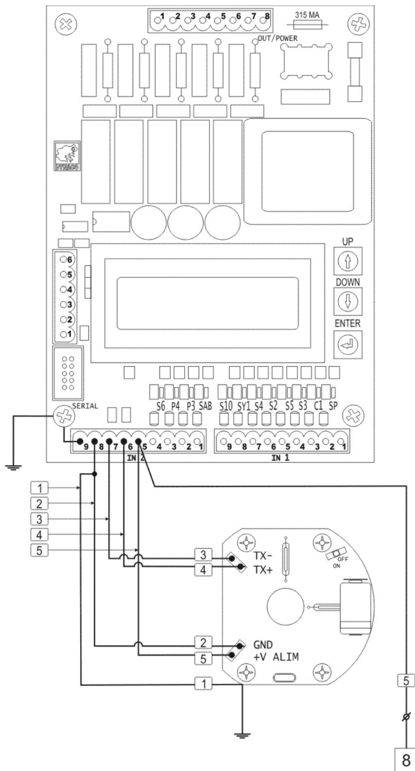
Рисунок 7-5. Соединение энкодера и платы управления.
